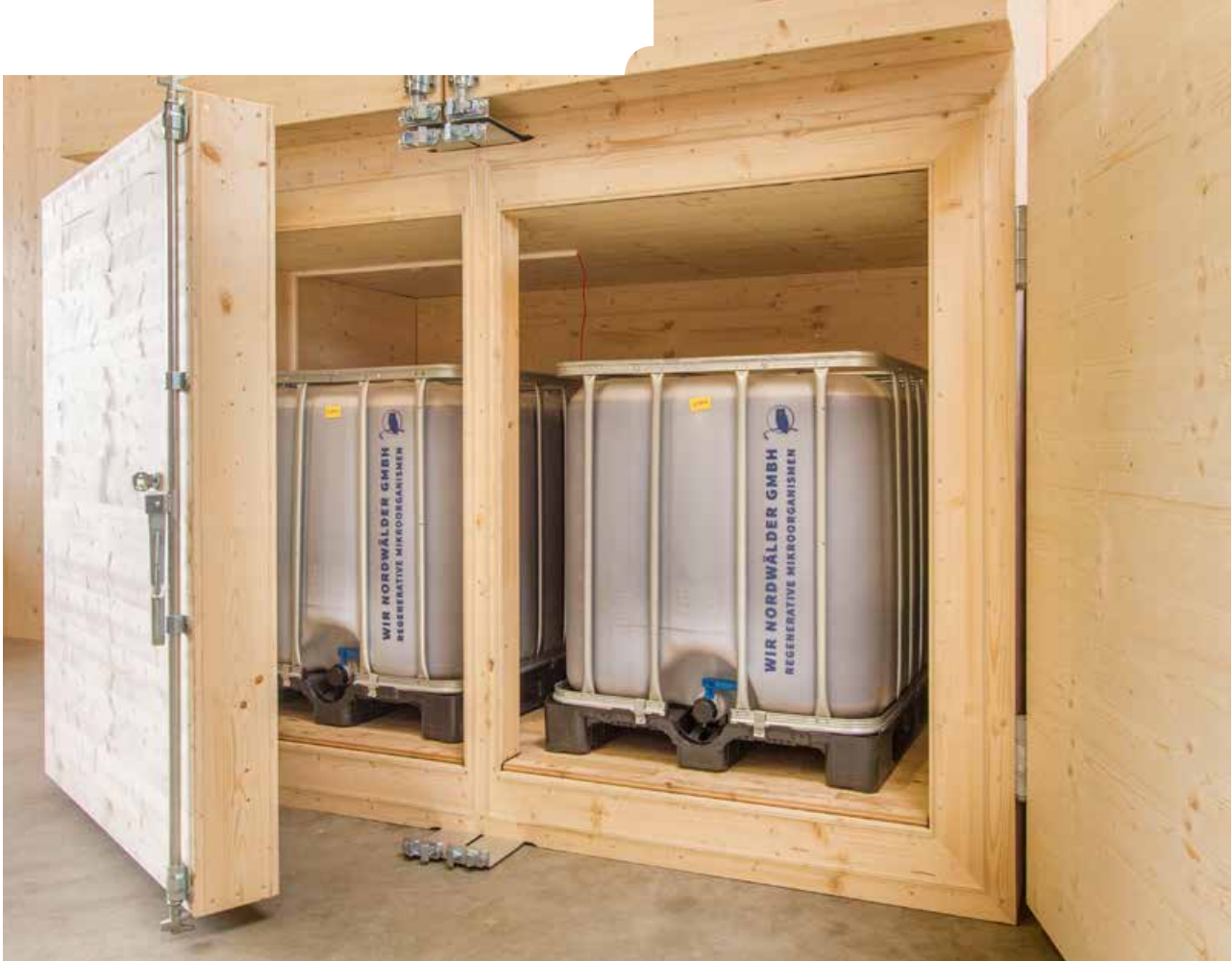
Der WIR Nordwlder RM-Fermenter im Einsatz (2000 Liter/Produktionszyklus)
